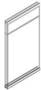
地槽系统 Bottom connection
